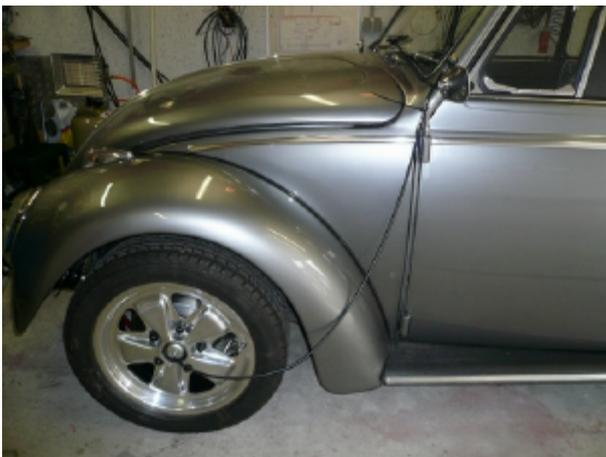
**Bild 4.1.1** Tachowelle außen verlegt
